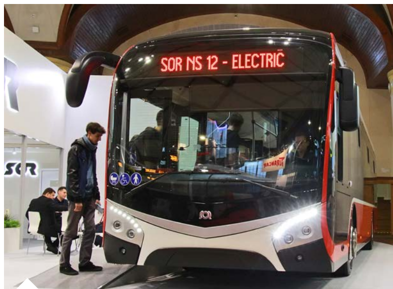
SOR trolejbus s pomocným bateriovým pohonem
