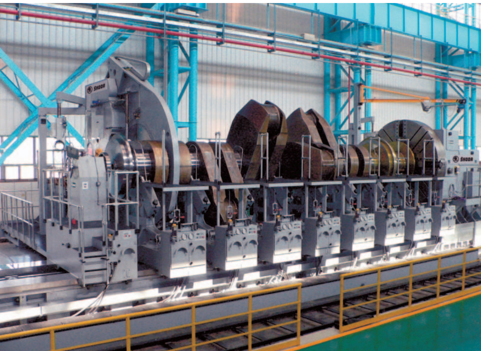
| Speciální soustruh na obrábění klikových hřídelí. Země dovozu: Čína. Vývozce: ŠKODA MACHINE TOOL a.s.
