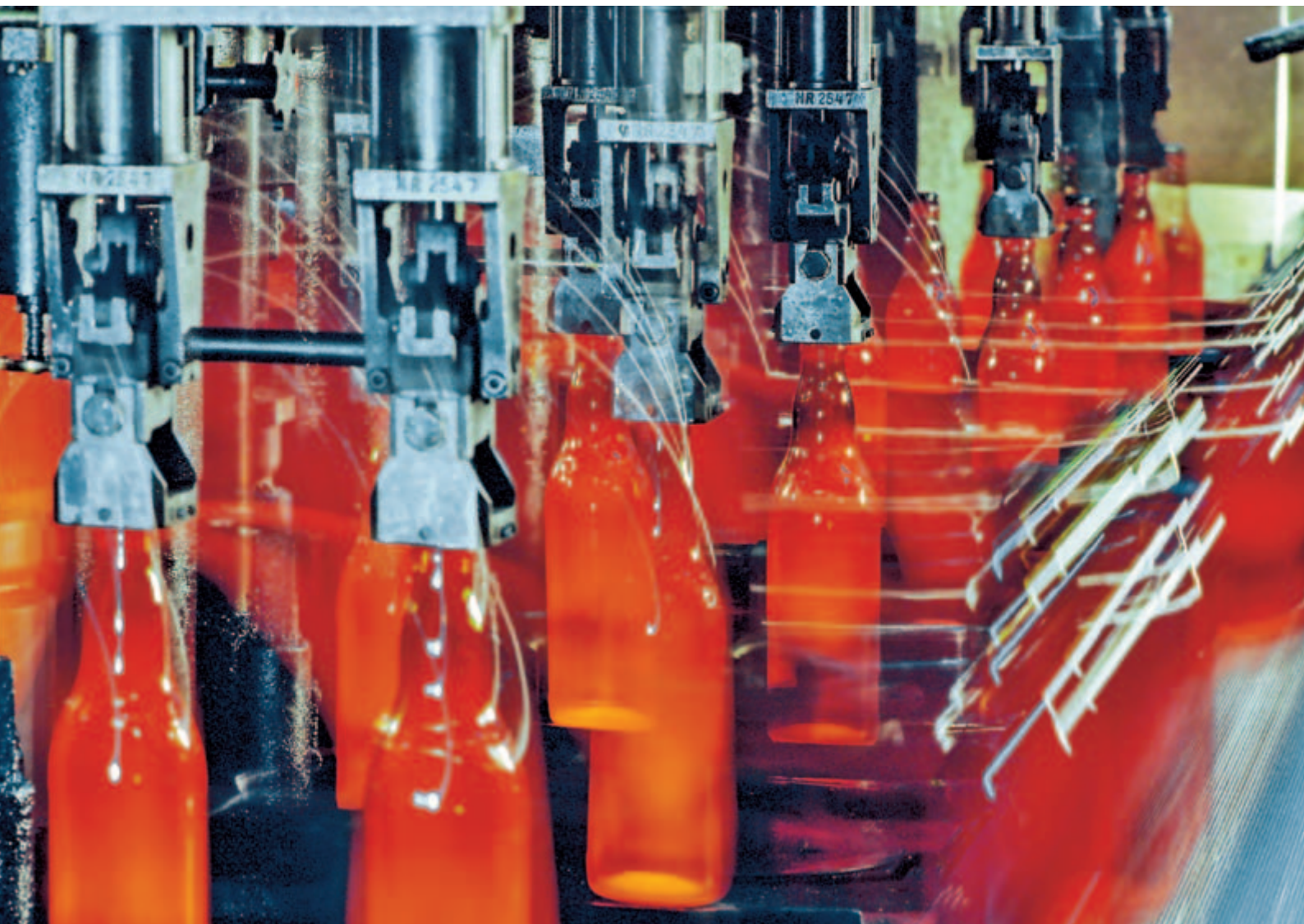
| Linka na výrobu obalového skla. Země dovozu: Ukrajina. Vývozce: Sklostroj Turnov CZ, s.r.o.
